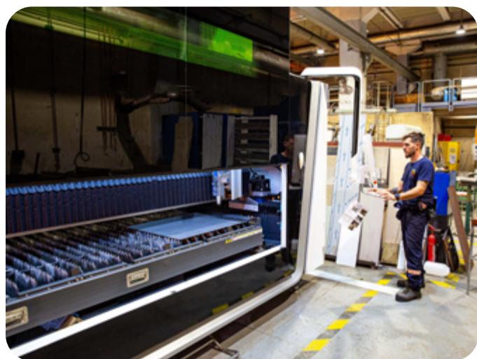
À l'atelier chaudronnerie, une table de découpe au laser de dernière génération.
