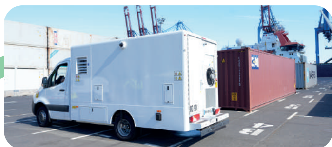
Le scanner mobile vient se positionner près du conteneur ou du véhicule à sonder.
