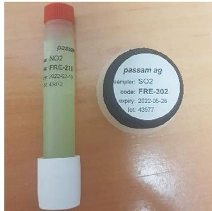
**Capteurs passif (SO<sub>2</sub> et NO<sub>2</sub>)**
