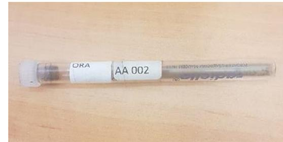
**Capteurs passif (C<sub>6</sub>H<sub>6</sub>)**
