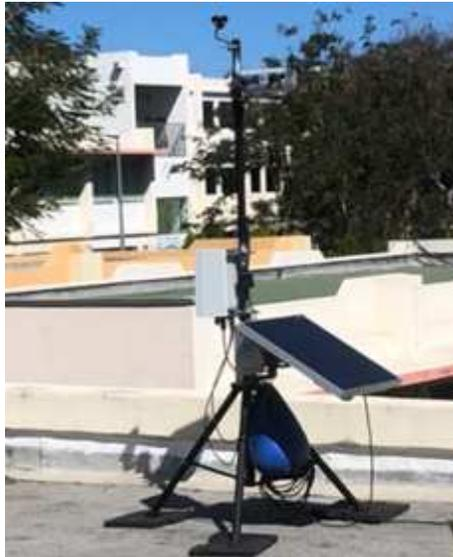
**Micro-capteur de particules (PM10 et PM2.5)**
